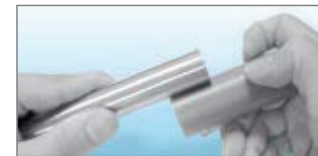
4. Das Rohr auf die Oberfläche des Rohrmarkers setzen und sehen, ob die Linie am Rohr sichtbar ist oder nicht.
