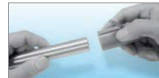
1. Rohr in den Rohrmarker stecken.
