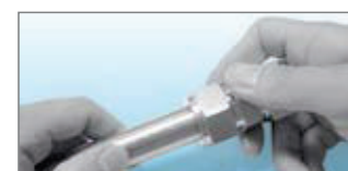
5. Das Rohr in die Hy-Lok Verschraubung einsetzen und sicherstellen, dass die Linie des Rohrmarkers nicht sichtbar ist. Das Rohr ist nun korrekt eingesetzt und das Gewinde kann angezogen werden.
