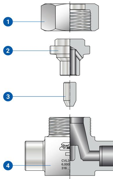
**Hinweis:** Funktionsbedingt müssen Rücklaufsperrren der Serie CVL wie oben abgebildet horizontal im Rohrleitungssystem installiert werden.
